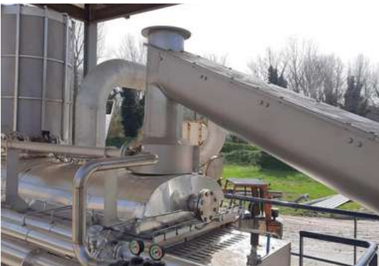
Transportador canal para fangos con tolvas entrada a medidas y eje pivotante
