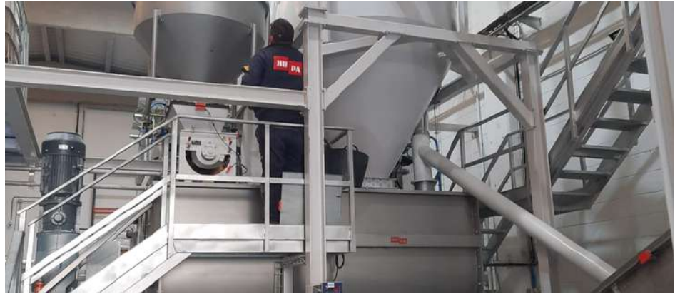
Mezcladora de cintas, conjunto pasarelas, y transportador canal
