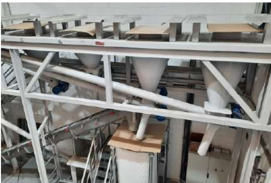
Conjunto transportador canal, descargadores de big bags y transportadores sinfín
