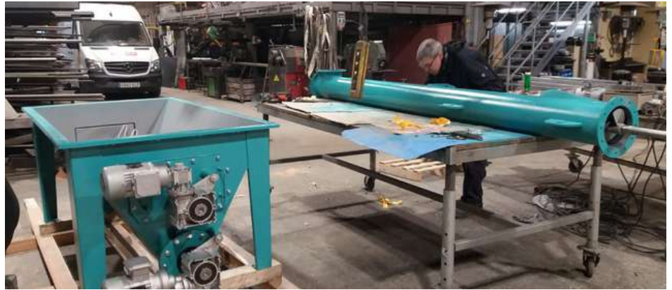
Conjunto tolva con hélice y sinfín para sílice
