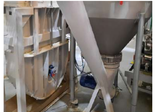
Elevador de cangilones auto limpiante para piensos, con pasarelas y escaleras para un fácil mantenimiento
