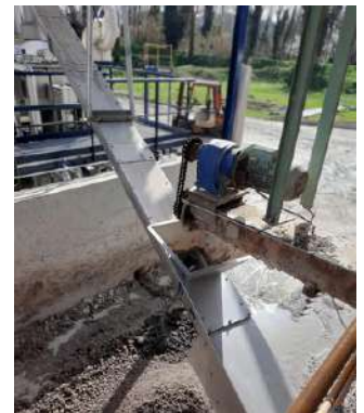
Transportador canal para fangos con tolvas entrada a medidas y eje pivotante
