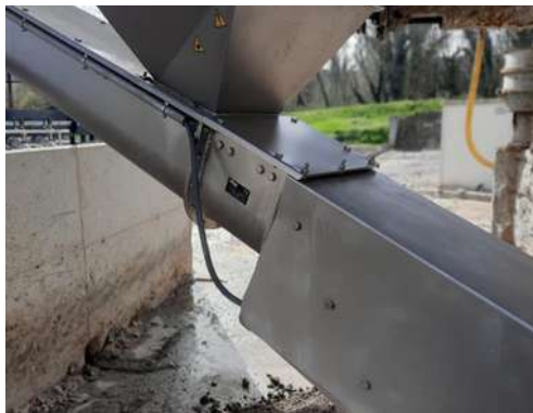
Transportador canal para fangos con tolvas entrada a medidas y eje pivotante
