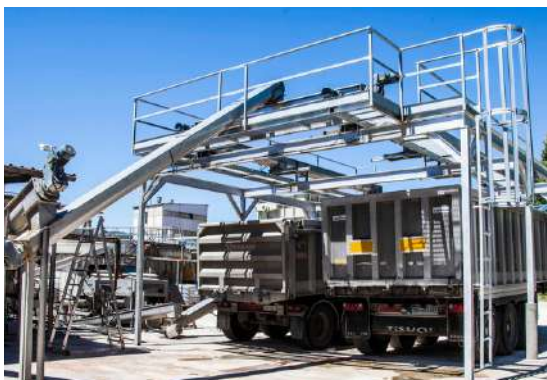
Conjunto transportadores canal con revestimiento de polietileno y eje hueco
