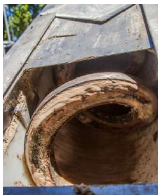
Conjunto transportadores canal con revestimiento de polietileno y eje hueco
