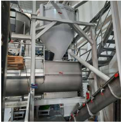
Mezcladora de cintas, conjunto pasarelas, y transportador canal
