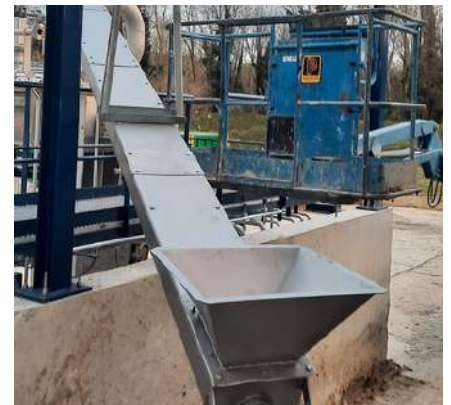
Transportador canal con fondo polietileno
