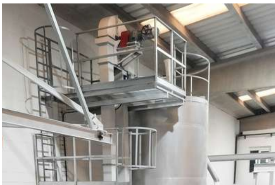
Elevador de cangilones auto limpiante para piensos, con pasarelas y escaleras para un fácil mantenimiento
