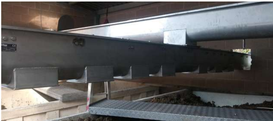
Transportadores canal, con 7 registros de salida para descarga uniforme en el depósito
