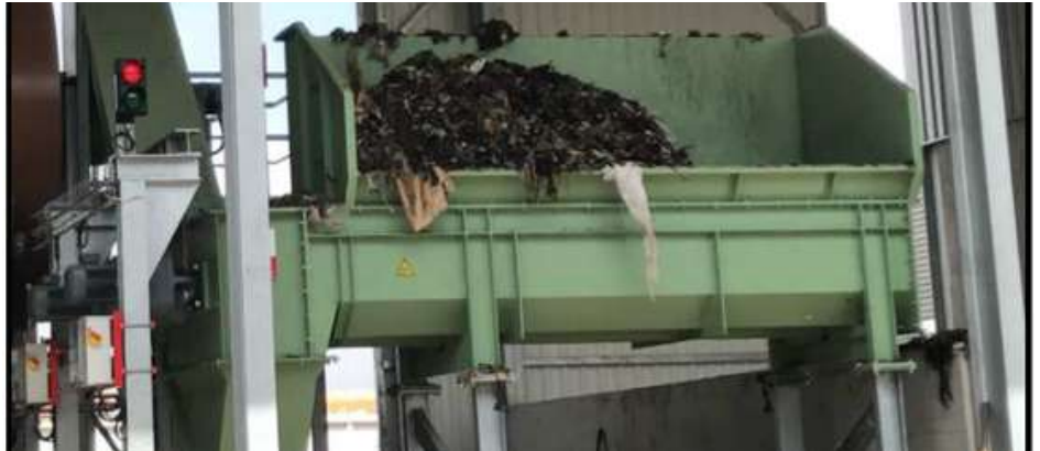
Transportadores de eje hueco para planta de residuos en Francia
