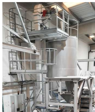
Elevador de cangilones auto limpiante para piensos, con pasarelas y escaleras para un fácil mantenimiento
