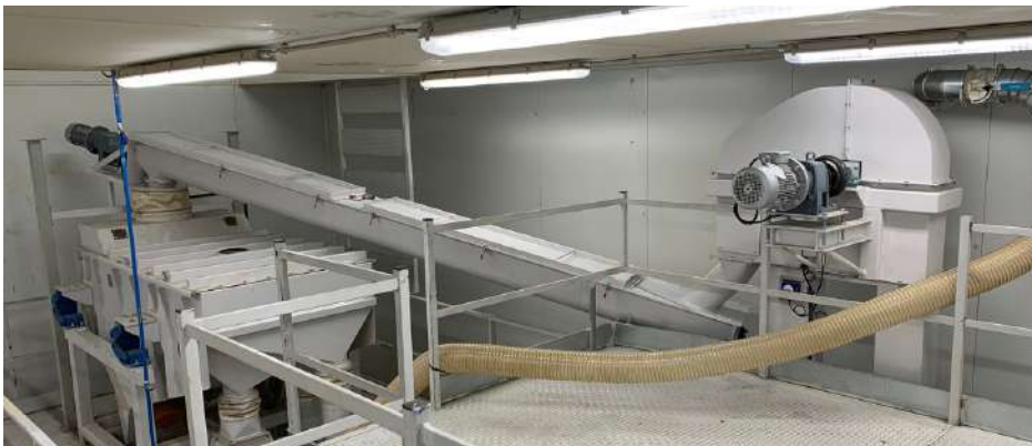
Elevador de cangilones y canales para hierbas de té
