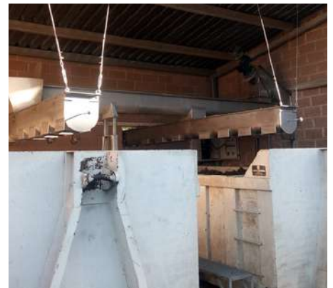
Transportadores canal, con 7 registros de salida para descarga uniforme en el depósito
