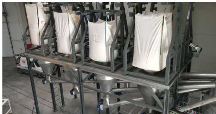
Descargadores de big bags, sinfines hasta tolva báscula
