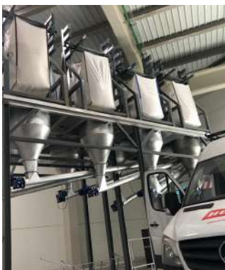
Descargadores de big bags, sinfines hasta tolva báscula
