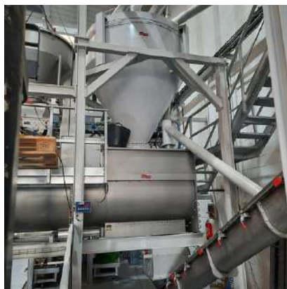
Barrejadora de cintes, conjunt passarel·les, i transportador canal
