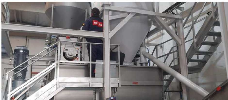
Barrejadora de cintes, conjunt passarel·les, i transportador canal
