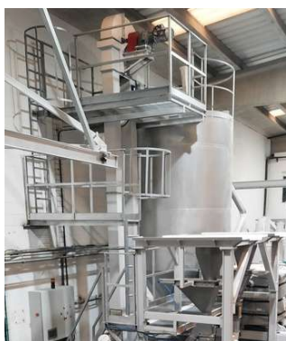
Elevador de canguilons autolimpiant per pinsos, amb passarel·les i escales per un fàcil manteniment
