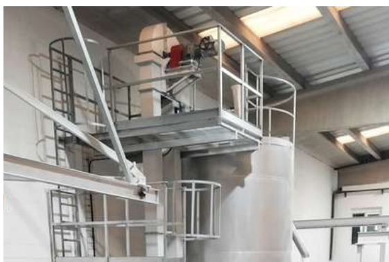
Elevador de canguilons autolimpiant per pinsos, amb passarel·les i escales per un fàcil manteniment
