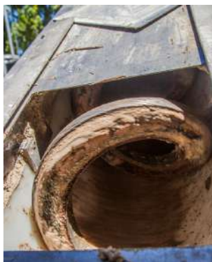
Conjunt transportadors canal amb revestiment de polietilè i rosca amb eix buit
