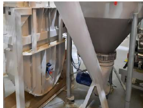
Elevador de canguilons autolimpiant per pinsos, amb passarel·les i escales per un fàcil manteniment
